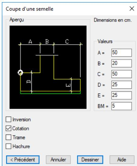
Permet de saisir les dimensions du coffrage. BM = béton maigre. Cliquez sur dessiner, puis sélectionnez le point d'insertion de la coupe sur le dessin.
