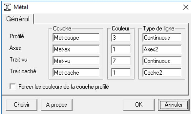
Si l'option "**Forcer les couleurs de la couche profilé**" n'est pas sélectionnée, tous les éléments seront dans des calques différents.
