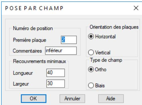
Cette commande permet de créer des champs armés avec des plaques de treillis.
