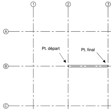
Permet de dessiner un mur le long d'un axe.
