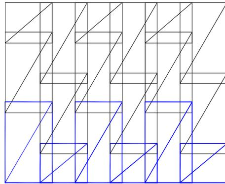
Pose horizontale: 6 plaques avec recouvrement 57.9cm
