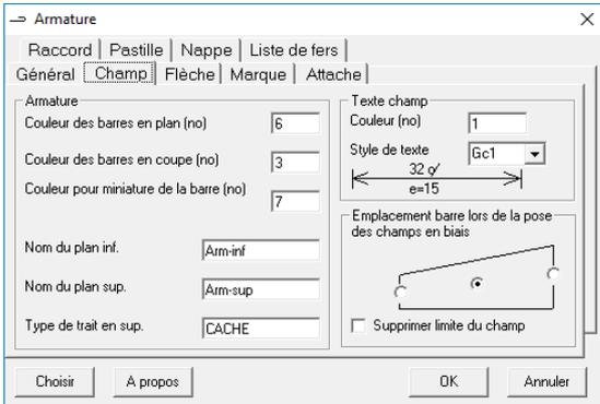
Cette fenêtre vous permet de régler les paramètres de représentation des champs d'armature.
