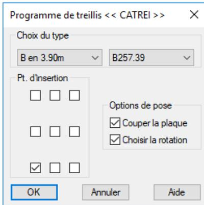
"**Choix du type**" permet de sélectionner le type et la section de treillis.
