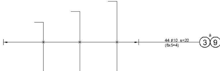
"**Déduction des enrobages**" permet de déduire directement l'enrobage sur une longueur pointée sur le dessin. La valeur de l'enrobage est définie dans les variables d'armature.
