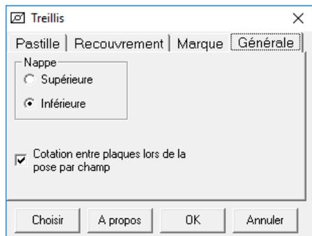
Permet de sélectionner la "**Nappe**" à armer, CadARM crée un calque d'armature pour le treillis selon la nappe indiquée.
