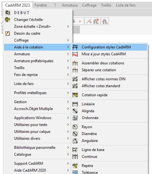
Principe : le style de cote 0\_CONFIG\_DEFAULT est généré par CadARM, ce style sera utilisé comme modèle pour les cotations. Vous devez saisir les paramètres de cotation dans les onglets de manière traditionnelle. Les dimensions doivent être saisies en mm papier (pas en cm !)
