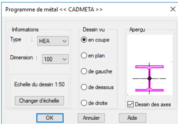
"**Informations**" permet de sélectionner le type de profilé et les dimensions. L'aperçu se met à jour en fonction de la sélection.
