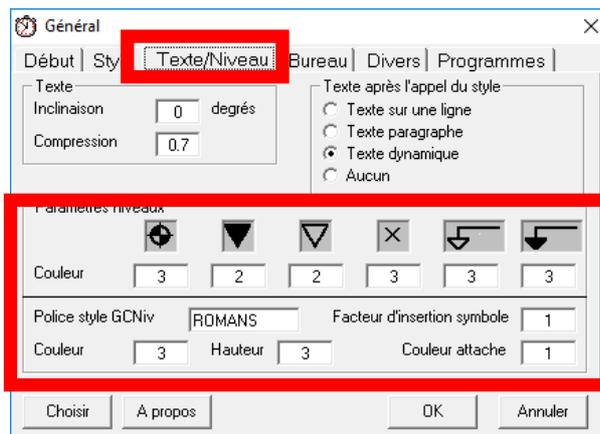
Utilisez la commande « Dessin du niveau » pour dessiner les niveaux avec les nouveaux paramètres. Attention après le paramétrage des niveaux. La nouvelle configuration sera effective lors du commencement d'un nouveau dessin.
