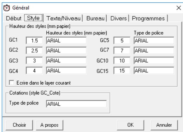
"**Hauteur des styles**" permet de définir la hauteur de texte et le type de police pour les styles de texte CadARM. Entrez la hauteur en mm sortie papier, la hauteur correcte sera calculée par CadARM en fonction de l'échelle de travail.
