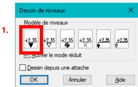
"Dessin depuis une attache" permet de dessiner le niveau à l'extrémité d'une ligne de repère.
