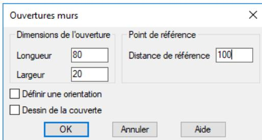
"**Dimensions de l'ouverture**" : indiquez la longueur et la largeur de l'ouverture, attention : la largeur = épaisseur du mur.
