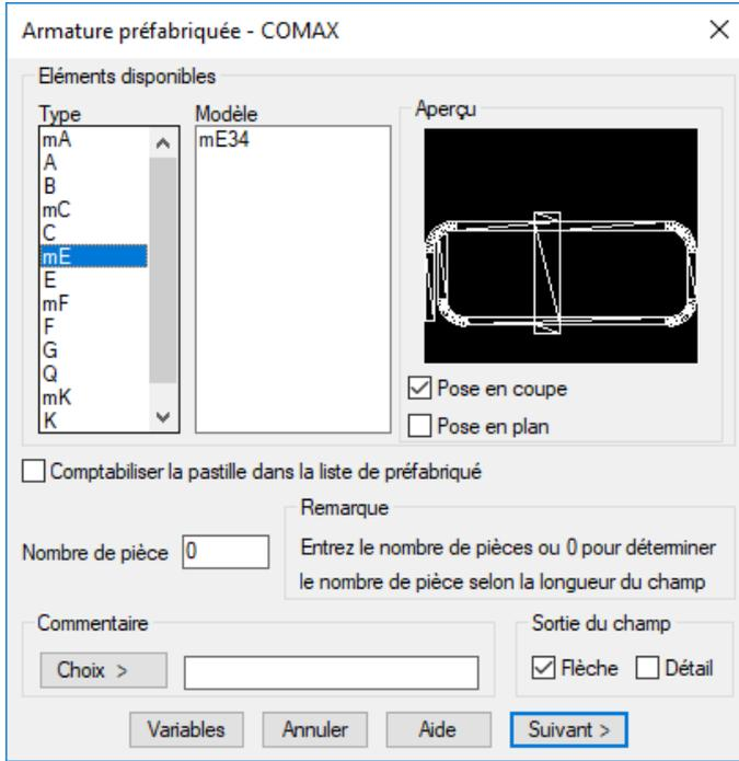
Sélectionnez le modèle et la section d'armature préfabriquée. Le modèle choisit et le type de dessin s'affiche dans la fenêtre.
