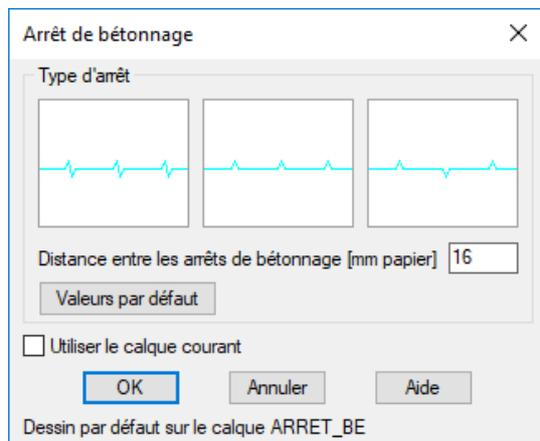
Permet de dessiner rapidement des arrêts de bétonnage.
