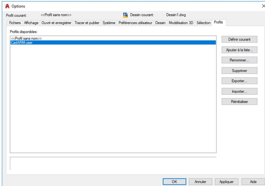
Permet de créer, sélectionner ou effacer un profil utilisateur. Les profils utilisateurs vous permettent de créer un environnement de travail avec les outils nécessaires en fonction du type de plan que vous devez réaliser, soit : coffrage, armature, métal...etc.
