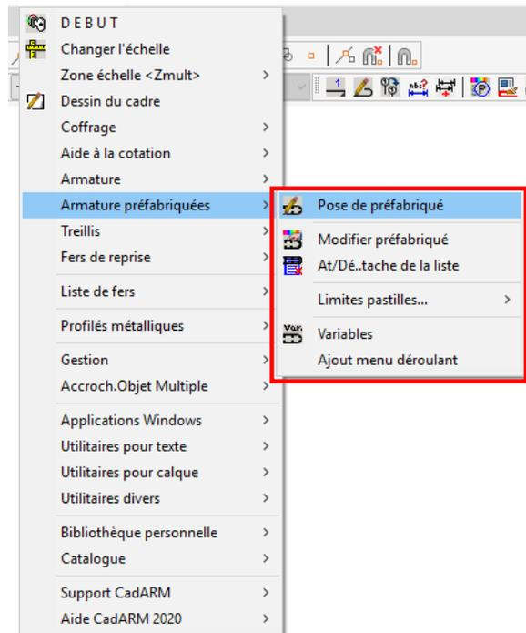
Sélectionnez dans les variables de CadARM, le type d'armature préfabriquée que vous souhaitez dessiner : Egcotec®, Comax® et EBEA®
