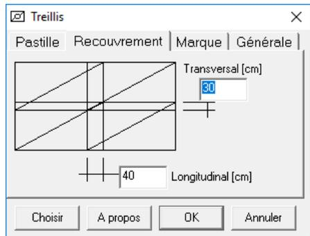
Permet de définir les recouvrements minimaux longitudinaux et transversaux.
