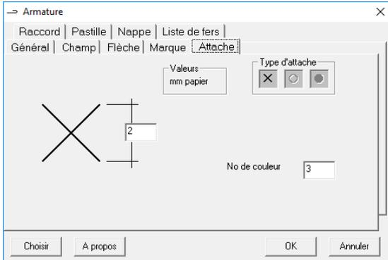
Permet de définir le symbole *Attache* qui sera dessiné à l'intersection entre une ligne de rappel et une barre d'armature.
