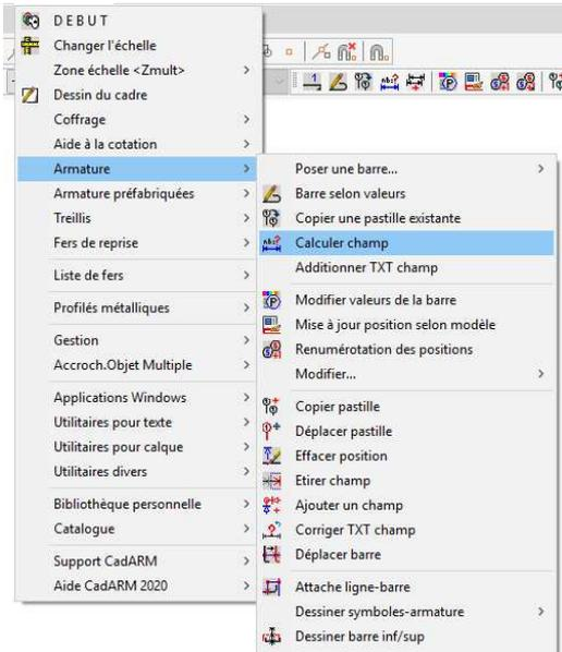
La commande « Calcul du champ » permet de déterminer le nombre de barre dans un champ d'armature. Vous pouvez soit choisir le champ en cliquant sur la ligne ou choisir le champ en cliquant les 2 points qui déterminent le champ. (Suivre les instructions dans la ligne de commande)
