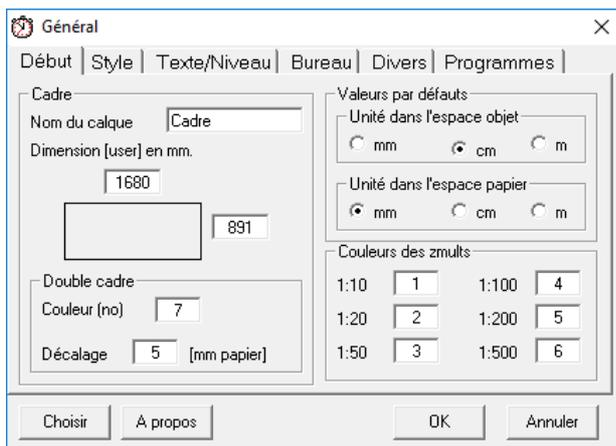
"**Cadre**" permet de paramétrer le cadre lors de la commande *Début*. Indiquez le "**Nom du calque**", les dimensions du cadre user, la couleur et le décalage pour le double cadre.
